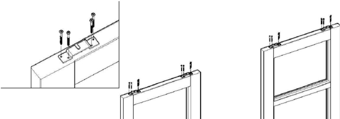
Hängen Sie nun die Türen ein und befestigen Sie sie mit Muttern. Die Türen müssen ohne viel Kraftanwendung einfach rollen. Falls dies nicht der Fall ist, müssen Sie die Türen nachjustieren. Dies geschieht mit den Schrauben und Muttern.
